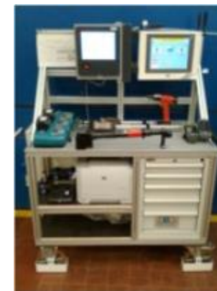
Maserati FMS stanowisko z kluczami dynamometrycznymi i narzędziami z zasilaniem kablowym i akumulatorowym
