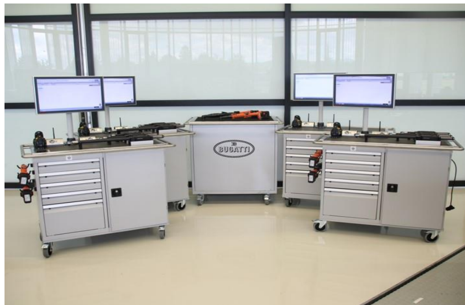
Bugatti FMS stanowisko z kluczami dynamometrycznymi i narzędziami skręcającymi z zasilaniem akumulatorowym
