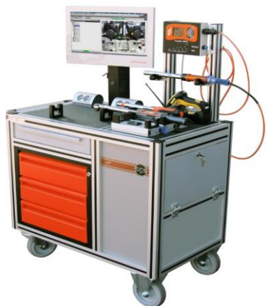
FCA FMS do budowy serii pilotażowych z narzędziami i kluczami z kontrolą momentu
